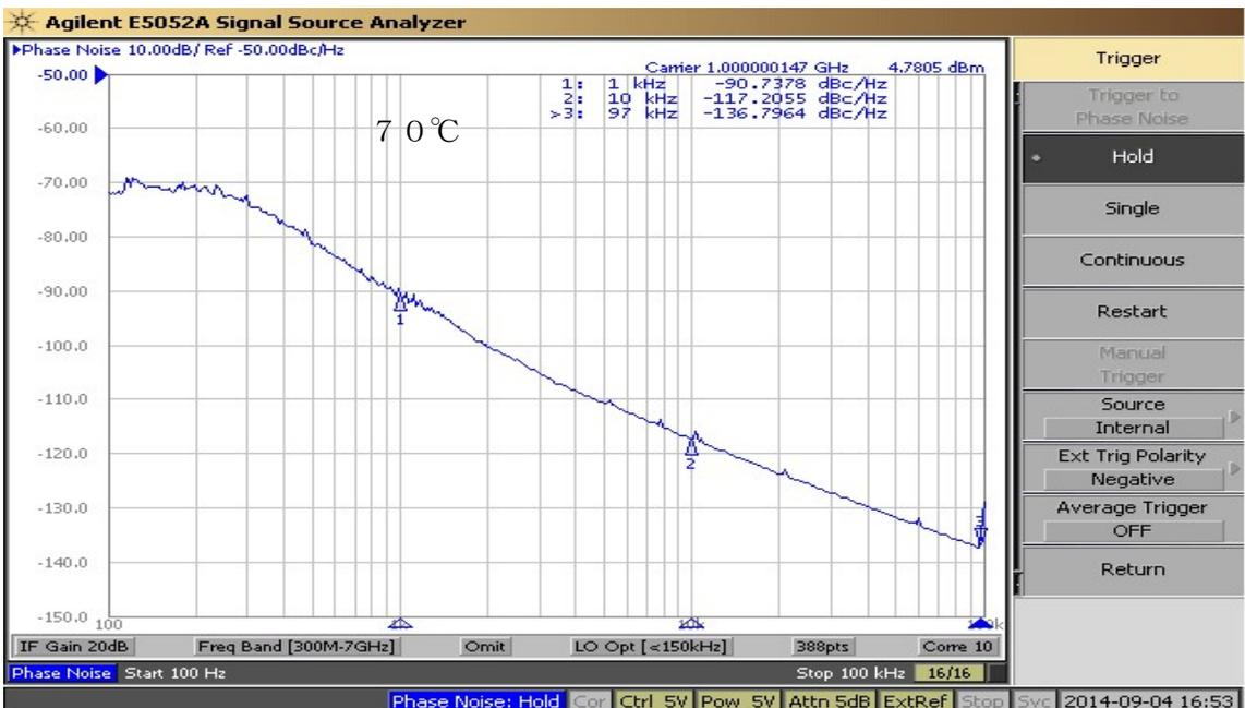
1000MHz FSK PLO 温度特性 温度変化に対してC/N安定度を表しています。
